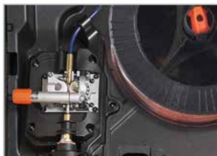
Modele Kempact 181/251 posiadają 2-rolkowy mechanizm podający GT02C.
